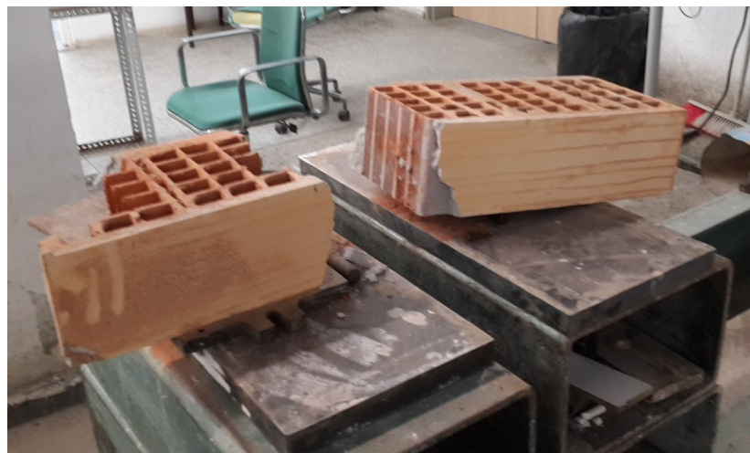
Figure 4.11. Shear failure of the test specimen (EN 1052 – 3).
