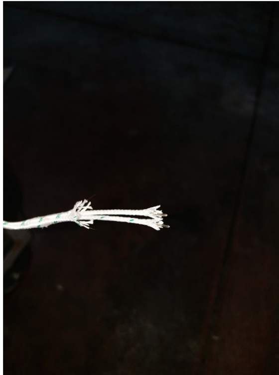
Figure 3.4. 0,8 mm Type K wire thermocouple wire.
